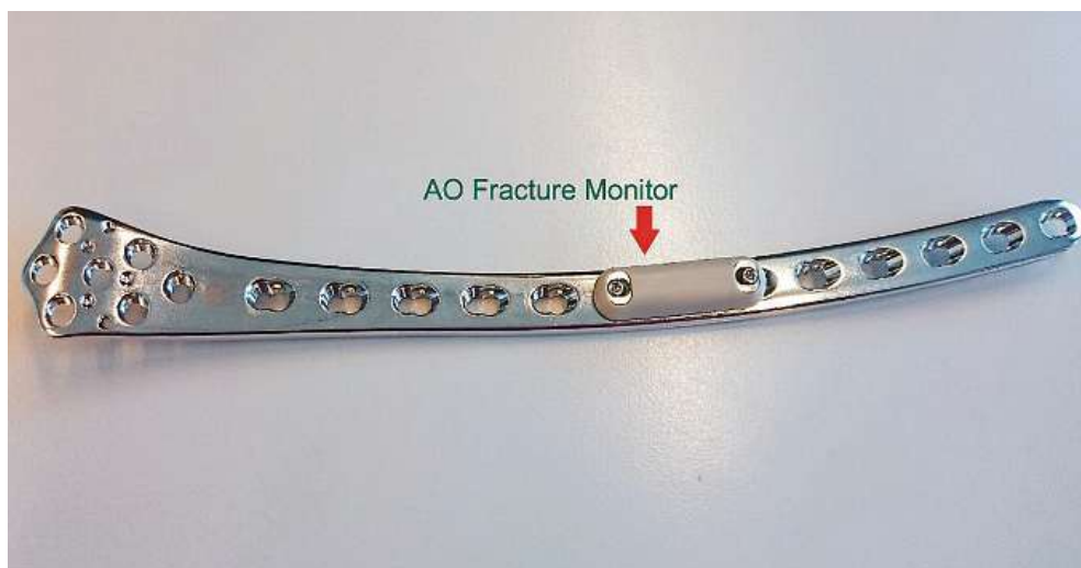
Der Prototyp des «AO Fracture Monitor» auf einer Platte zur Behandlung von Knochenbrüchen am Oberschenkel. Pressebilder
