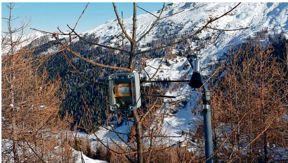
Der Baumneigungssensor ist in einem wasserfesten Gehäuse an einer Lärche befestigt. Bilder SLF/Heinen
