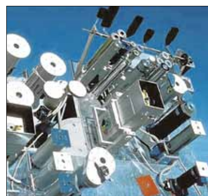
Die sogenannte Weltstandardgruppe misst die direkte Sonnenstrahlung. Bild PMOD/WRC
