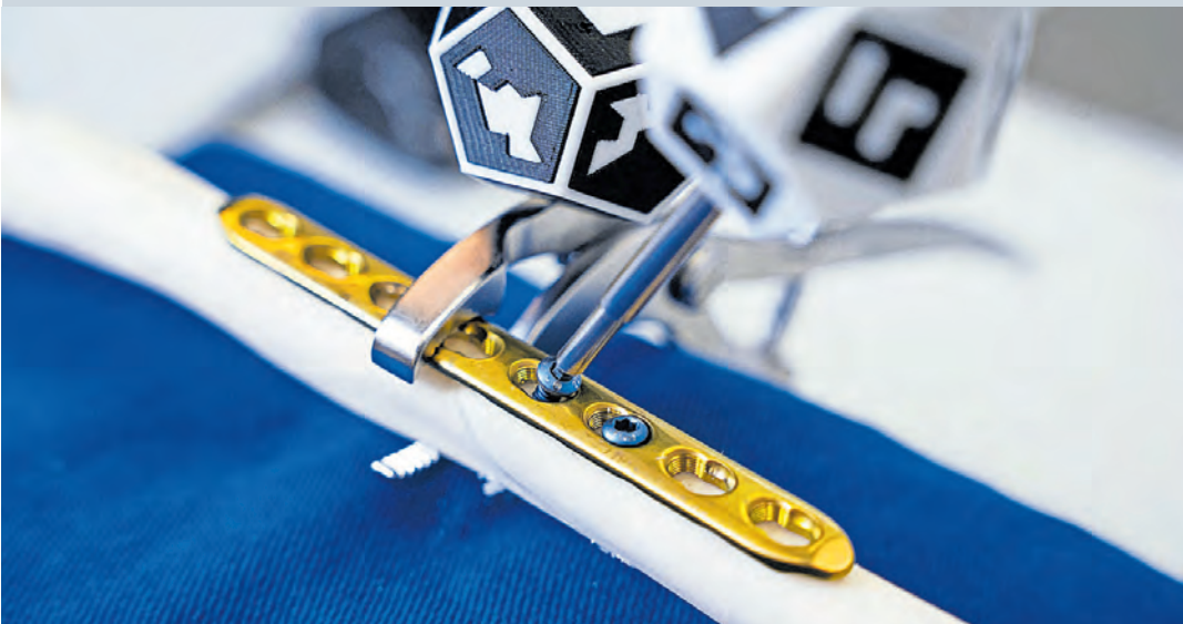
SMART SYNBONE im Einsatz: Optische Tracking-Marker erfassen in Echtzeit, wie eine Platte am Kunstknochen fixiert und verschraubt wird.
