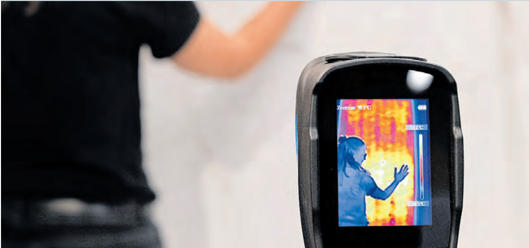
Heat+Wall: Die in das Wandpaneel integrierte Heizschicht macht sich per Wärmebildkamera sichtbar.
