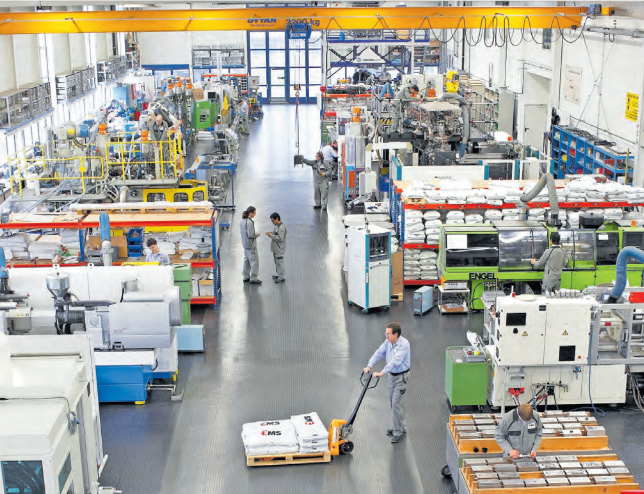
Im Technikum der EMS-Anwendungsentwicklung in Domat/Ems werden Bauteilprototypen für Kunden spritzgegossen.
