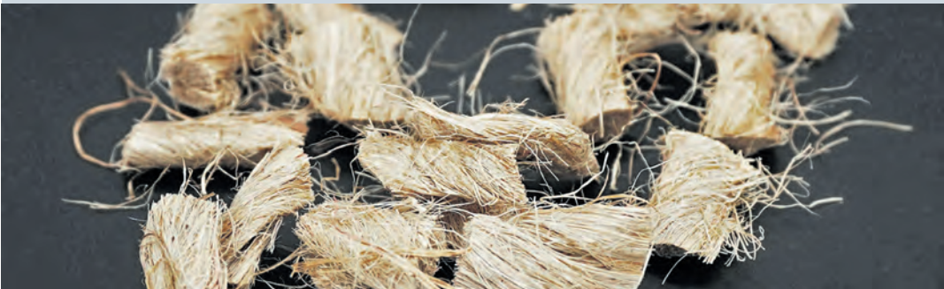
Naturfasern im Test: Contec Fiber erforscht deren Einsatz im Brandschutz für den Tunnelbau.
