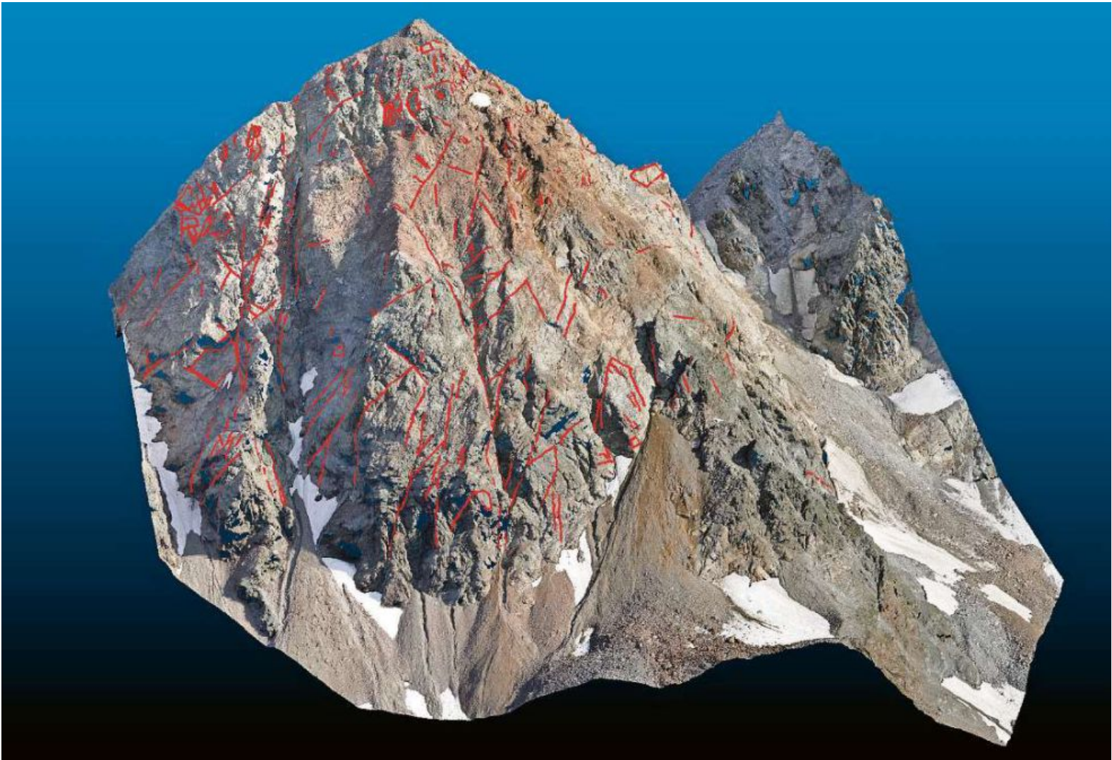
Dank hoch aufgelöster Aufnahmen von geologischen Oberflächen können Risse und Spalten in Gesteinskörpern dank entsprechender Algorithmen automatisch erkannt werden, was die Qualität der Interpretation oft verbessert und dabei Zeit und Kosten einspart. (FOTO ZUR VERFÜGUNG GESTELLT VON WSL-SLF, DR. ANDREA MANCONI UND BENJAMIN KRESSIG)
