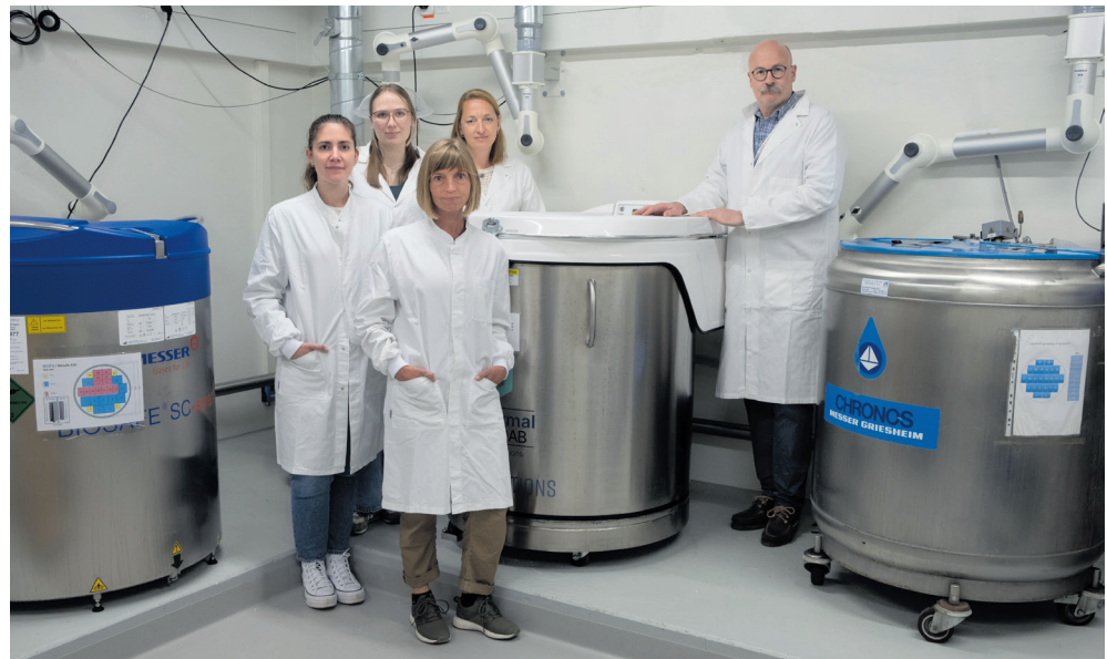
Das Team von DBS in der Biobank, wo die biologischen Proben bei -196^{\circ}\text{C} in flüssigem Stickstoff aufbewahrt werden. Quelle Foto: CK-CARE
