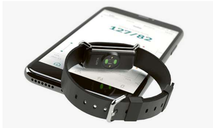
Ein am CSEM entwickeltes Armband zur kontinuierlichen optischen Blutdruckmessung . (FOTO AKTIIA.COM)
