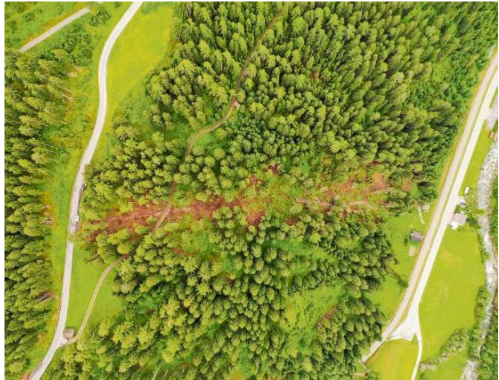
Flachgründige Rutschung im Lücherwald. Mittels Drohnenbildern charakterisieren die SLF-Forschenden die Waldstruktur (Foto: Alexander Bast, WSL-SLF).
