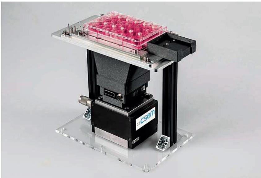
Erster Prototyp des optischen Lesemoduls zur Kontraktilitätsmessung.
