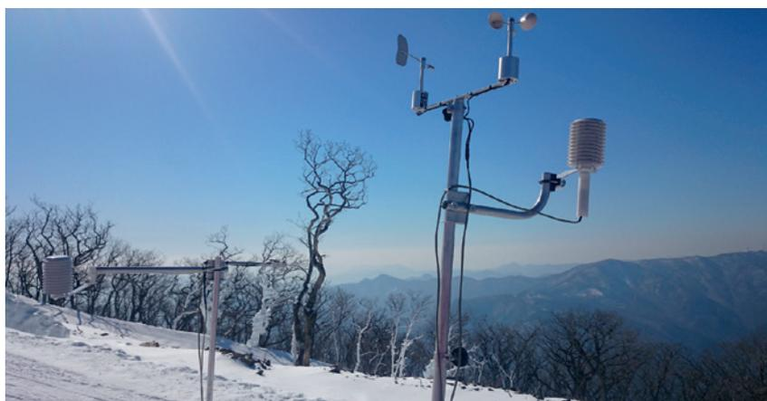
Die mobile Messstation misst am Pistenrand in Pyeongchang Luft- und Schneetemperatur sowie Wind- und Strahlungswerte.
