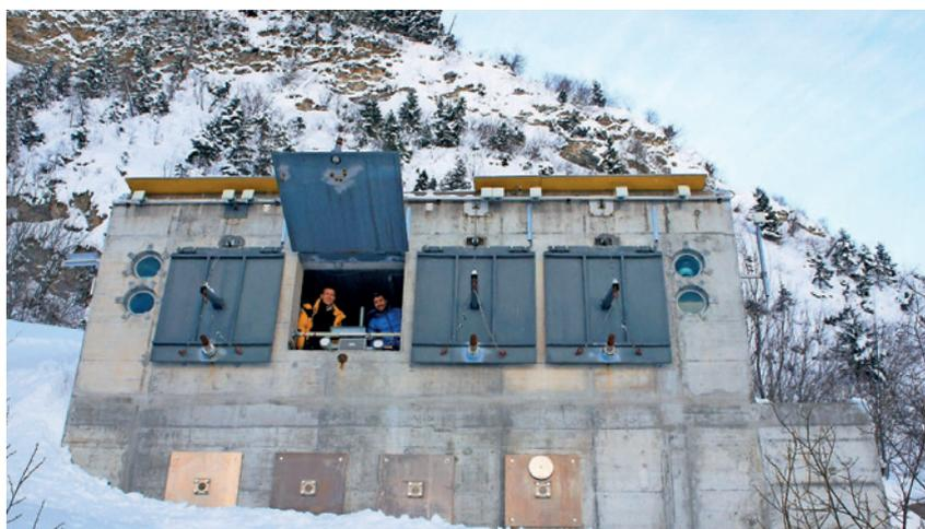
Mit einem Radar untersuchen Forscher vom Beobachtungsbunker aus das Fliessverhalten von Lawinen. Die Radarantennen befinden sich rechts neben der geöffneten Fensterklappe. Foto: Yann Gross
