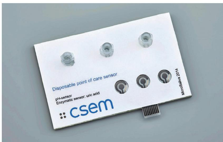
Prototyp mit Sensoren für die Speichelüberwachung zu Hause.
