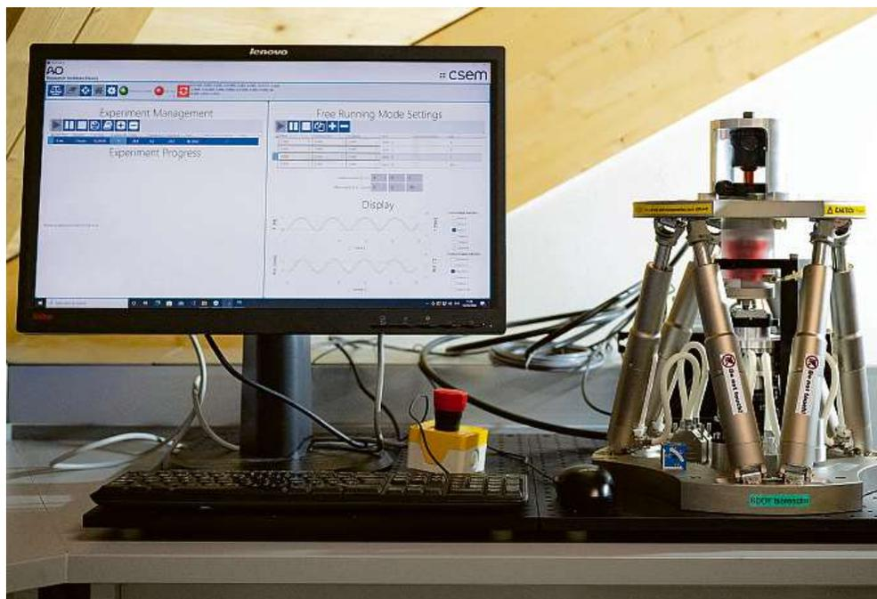
Das Bewegungs- und Belastungsmuster des multiaxialen Bioreaktors wird softwaregesteuert. Bild AO Foundation Communication & Events
